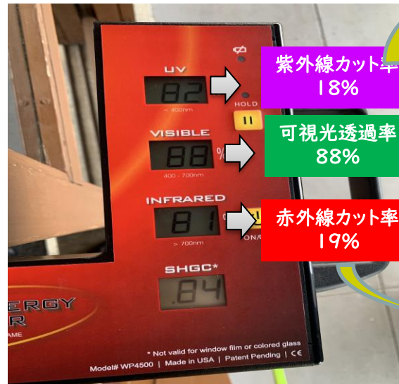
施工前の窓ガラス面
