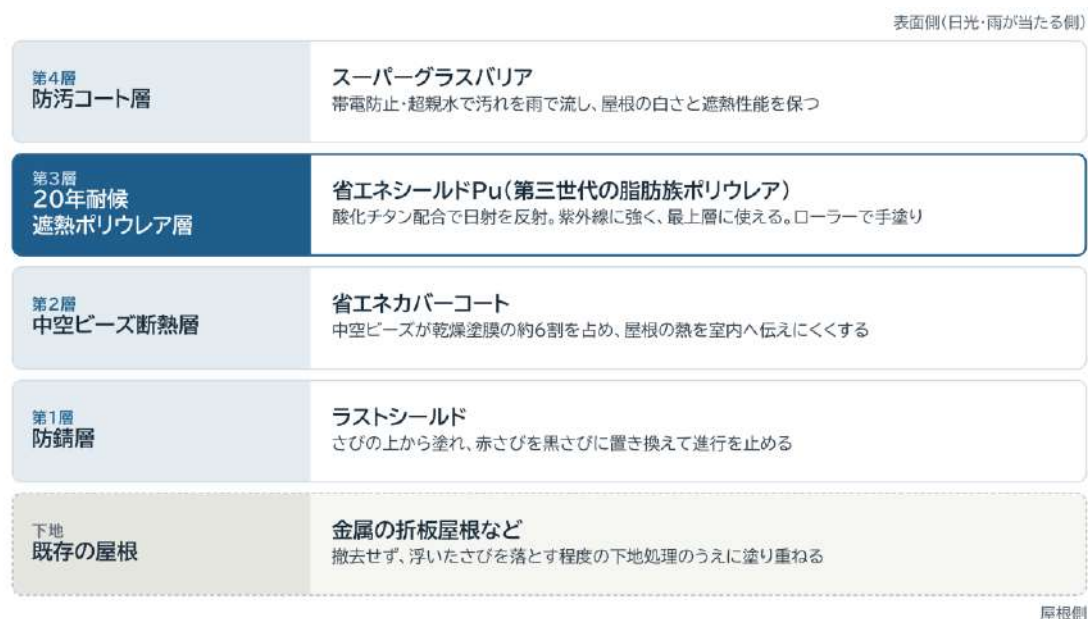
図2 省エネトリプルガードコートの4層構造(金属の折板屋根の場合)
