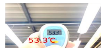
断熱塗装なし室内天井温度
